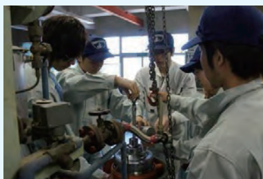
油清浄機の分解組立
