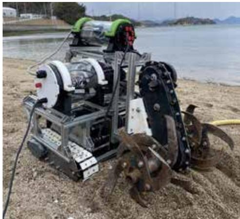
図1 自走式海底耕耘ロボット
