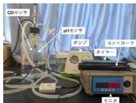
図 2 pH・細胞濃度自動計測装置
